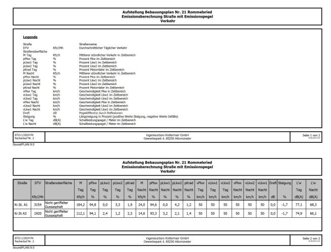
Zuschläge für Steigungen ermittelt die Berechnungssoftware anhand des hinterlegten digitalen Geländemodells automatisch.
