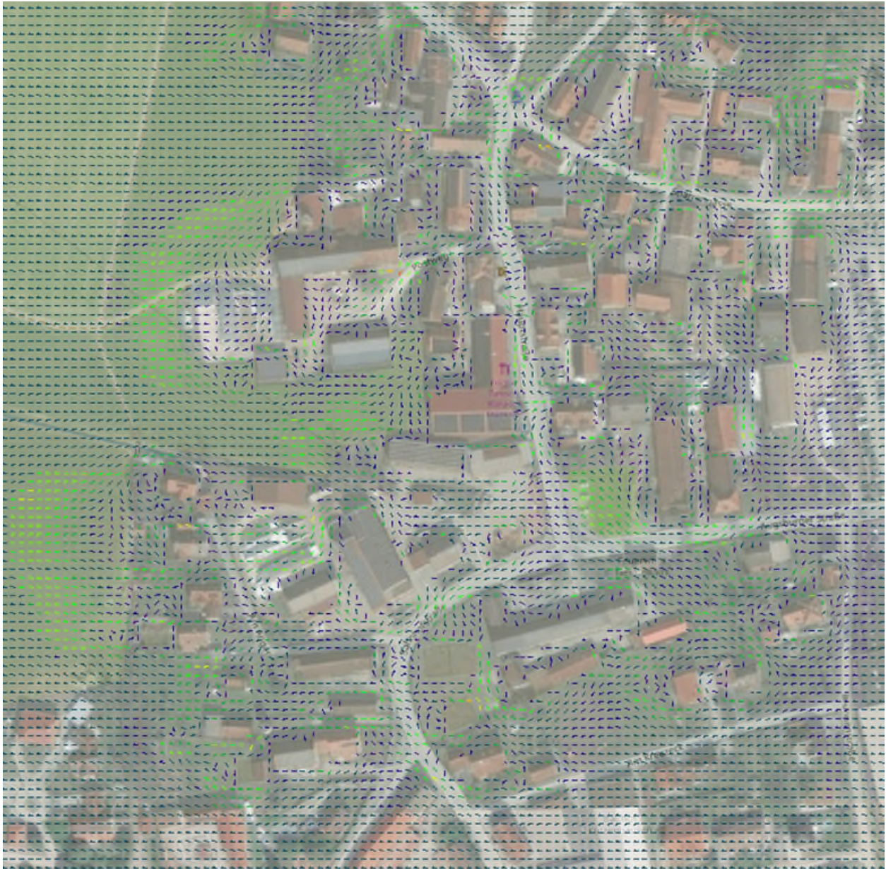
Abbildung 9: Ausschnitt Windfeld in der Anlagenumgebung mit Gebäudeumströmung - Höhe 3m; Anströmung aus 90 Grad (Ausbreitungsklasse AK III_1) (Quelle Hintergrund: austa!)
