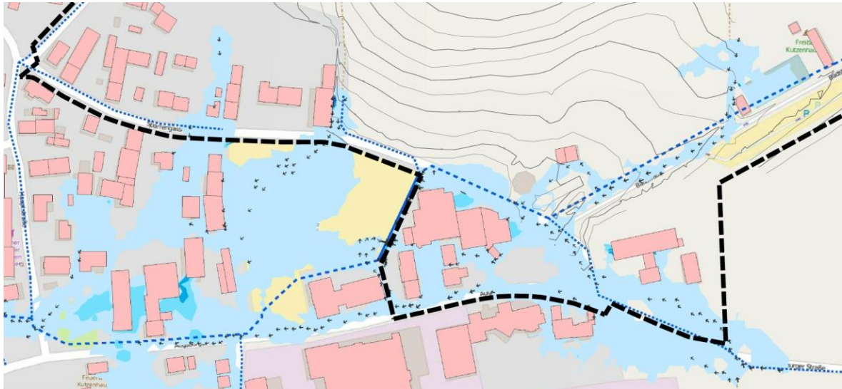
Abb. 14: Lageplan Überflutung HQ 100, o.M. (Quelle: Grontmij GmbH)
